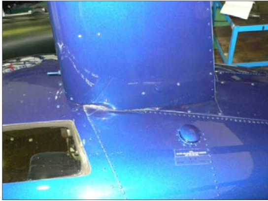
マスト・フェアリング 左側下部の変形
