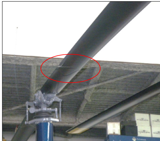
メイン・ローター・ブレード下面のしわ
