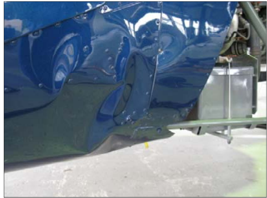
胴体左外板の座屈
